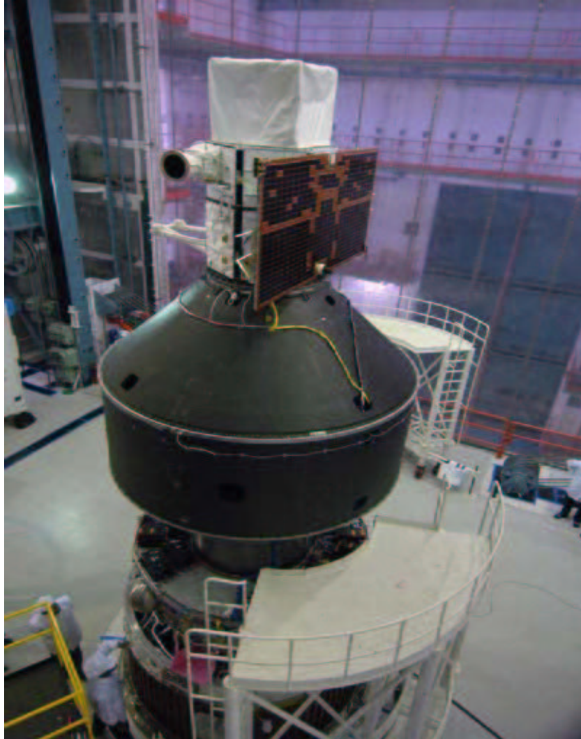
Figura 4.2: AGILE pronto per il lancio. Sono evidenti nel contesto le piccole dimensioni ed è ben visibile la maschera codificata.
